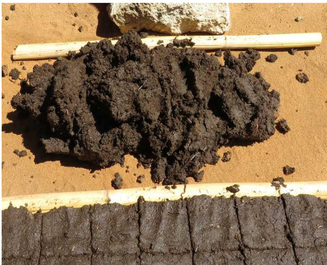
Bien presser pour compacter et mettre à plat au niveau des pièces
